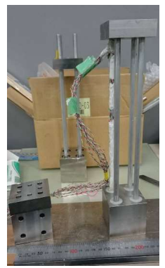
杭模型組み立て中
