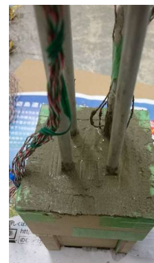
改良地盤を作製中
