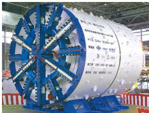
写真-1 掘削で用いられたシールド機 2)
