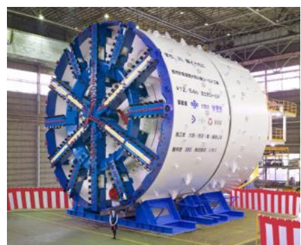
写真4 泥土圧シールド機 6)
