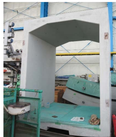
写真5 ボックスカルバート
